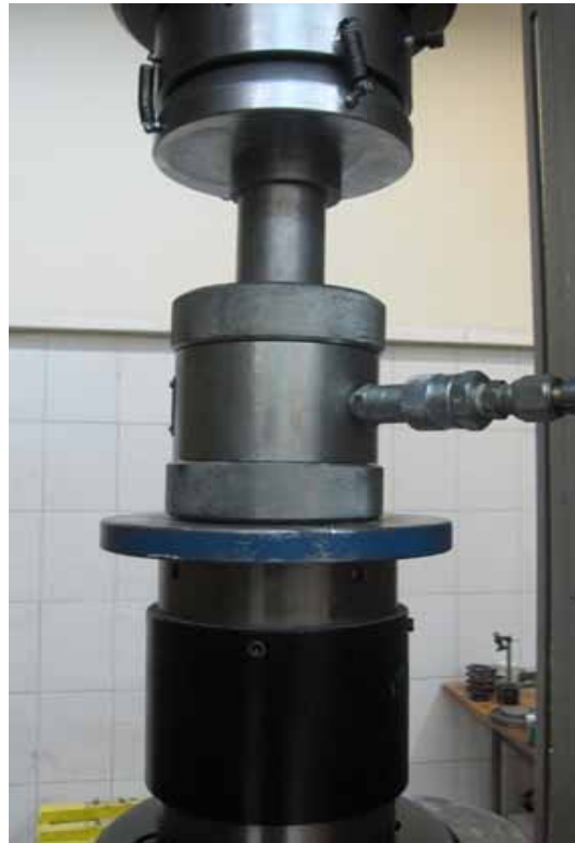
تصویر ۲- نمونه در سلول هوک تحت آزمایش سه محوره
