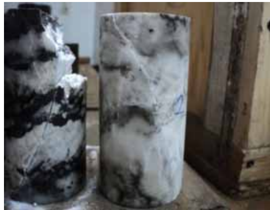
تصویر ۷- شکست برشی در نمونه پس از بارگذاری
