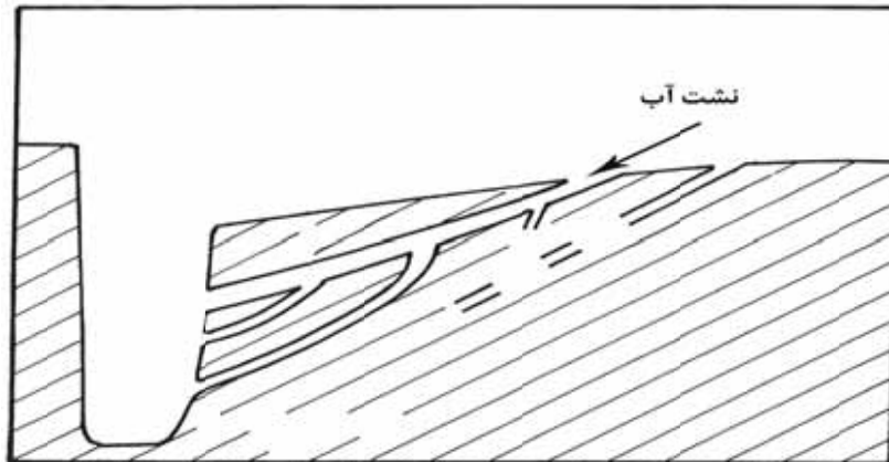
تصویر ۱۱- نحوه شکل‌گیری کارن‌های حفره‌ای در امتداد درزه‌ها و شکستگی‌ها.
