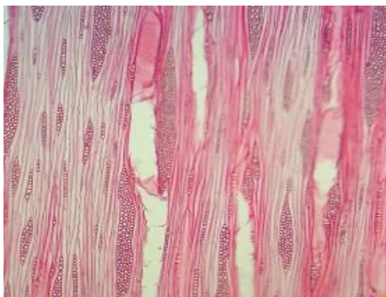
شکل ۹- مقطع مماسی گونه افرا پلت دست کاشت (بزرگنمایی 50x و 70x)
