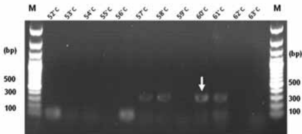
شکل ۱: بهینه سازی دمای مرحله اتصال PCR. بیشترین محصول در دمای ۶۰°C تولید شده است. M: مارکر DNA.
