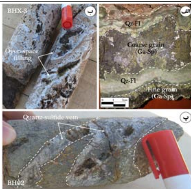
شکل ۹. ساخت و بافت کانی‌سازی در منطقه گلوچه شامل: الف) ساخت نواری (Crustiform) متشکل از گالن (Ga) و اسفالریت (Sp) ریزبلور در حاشیه و درشت‌بلور در مرکز به‌همراه باطله کوارتز (Qz) و فلوریت (Fl)، ب) ساخت سیلیسی پرکننده فضای خالی (Open-space filling) در گمانه شماره BHX-3 (عمق ۳۰ متر) و پ) ساخت رگه-رگه‌چهای کوارتز-سولفیدی (گالن) در میزبان آندزیت توف در گمانه شماره BH02 (عمق ۴۵ متر)
