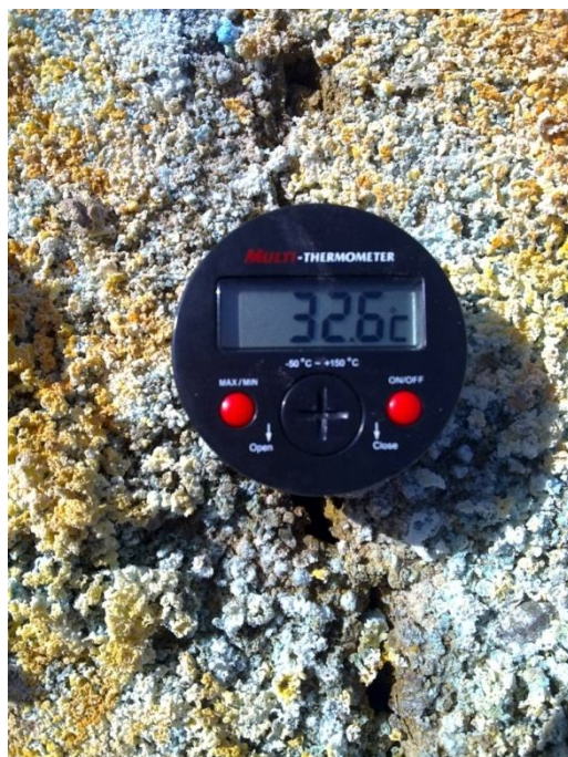
شکل 7. مجرای هوای گرم و مرطوب مشاهده شده در سطح کومه 19 که با تشکیل کانیهای ثانویه ملانتریت (کانیهای آبی رنگ) و رزونیت (کانیهای سفید رنگ) و اکسیدهای آهن (کانیهای نارنجی رنگ) همراه شده است
