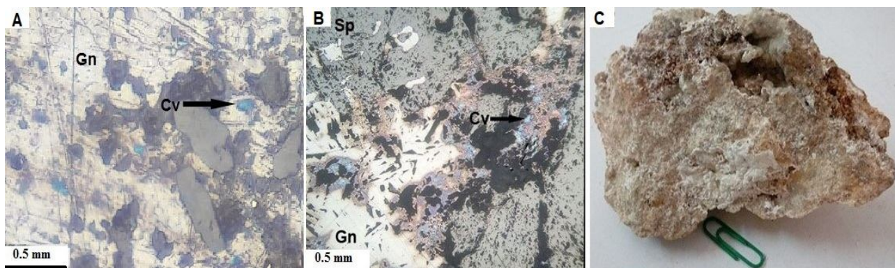
شکل ۶. A و B: تصاویر میکروسکوپی نور انعکاسی از کالکوپیریت جاننشین شده توسط کوولیت و C: تصویر نمونه دستی از اسمیت‌سونیت در کانسار طرز. علائم اختصاری کانی‌ها از ویتنی و اوانز (Whitney and Evans, 2010) اقتباس شده است (Sp: اسفالریت، Gn: گالن، Cv: کوولیت).
