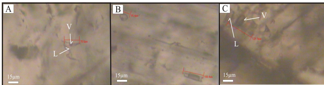
شکل ۸. تصاویری از میان‌بارهای سیال در کانی کلسیت از کانسار پیرمردان، A و B: شکل‌های نامنظم، کشیده و کروی میان‌بارهای سیال که از نوع اولیه هستند و C: همراهی میان‌بارهای غنی از بخار (V) و غنی از سیال (L) در کانی کلسیت
