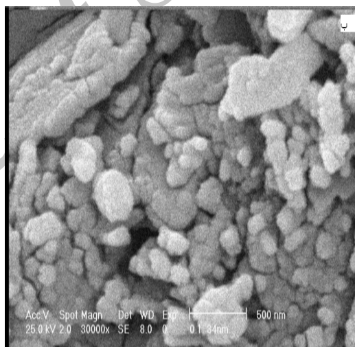
شکل ۶ تصاویر SEM کاتالیست V_2O_5/TiO_2/SiO_2
