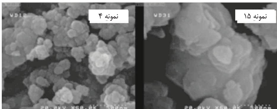
شکل ۳ تصویرهای SEM نانو ذرات منیزیم اکسید سنتز شده به روش آسیاب با زمان‌های متفاوت (نمونه ۱۴: ۶۰ ساعت و نمونه ۱۵: ۱۰۰ ساعت)
