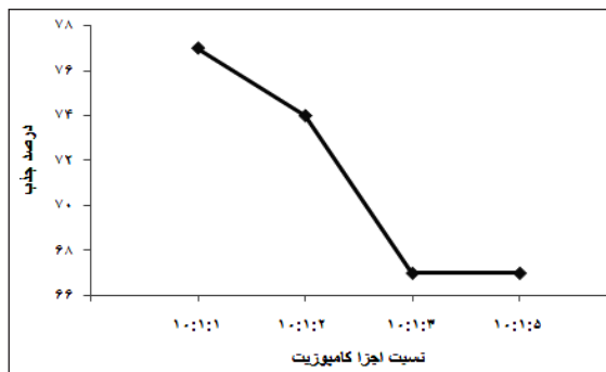
شکل ۱۰ نمودار درصد حذف یون روی به وسیله جاذب M-NC/HNT با تغییرات نسبت جاذب
