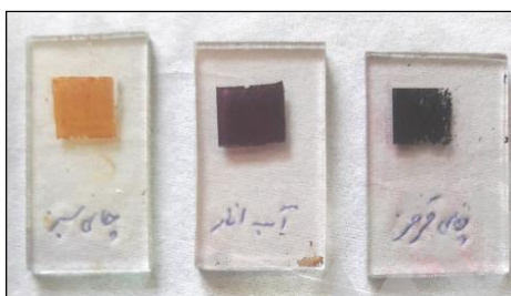
شکل ۱ الکترودهای آند پس از لایه‌نشانی TiO_2 و جذب رنگدانه روی آن.
