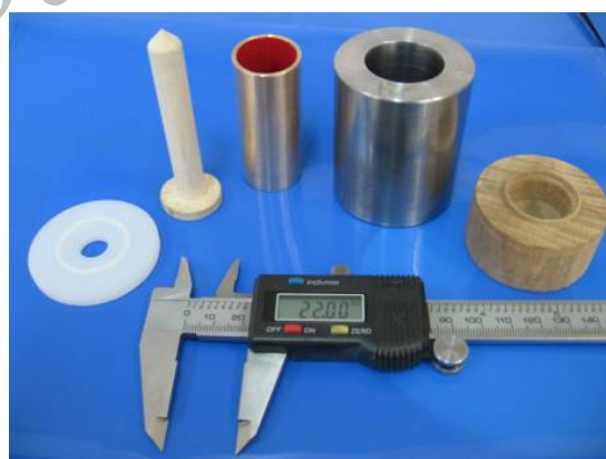
شکل ۵ لوله‌های فولاد St-۳۷ و فسفر برنز همراه با نگهدارنده‌های به کار رفته در آزمایشها [۷]
