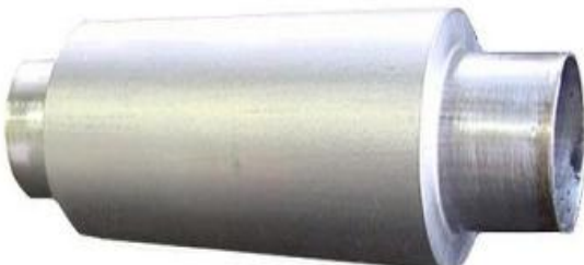
شکل ۱۵ لوله شکل داده شده با روش آزمایشگاهی در قالب جدید هیدروفرمینگ
