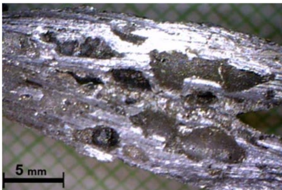
شکل ۷ درصد تخلخل با پاس‌های نورد؛ دمای فوم‌سازی برابر 680^{\circ}\text{C} ، نرخ گرمایشی برابر 10^{\circ}\text{C/s} و زمان فوم‌سازی برابر ۵ دقیقه
