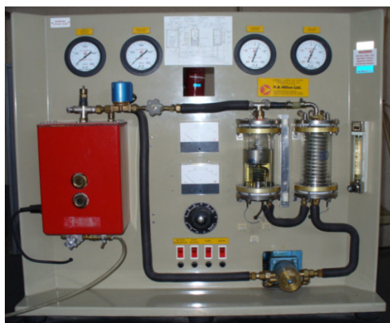
شکل ۱ دستگاه تبرید اجکتوری مورد استفاده در آزمایش‌ها
