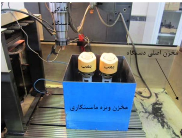
الف) نحوه قرار گیری مخزن ماشینکاری درون مخزن اصلی دستگاه
