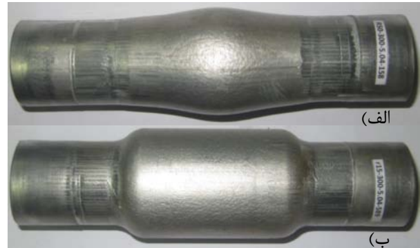
شکل ۹ پر نشدن کامل گوشه‌ها در بارگذاری مطابق شرایط نرخ کرنش 0.01/s ؛ (الف) نمونه ۱ و (ب) نمونه ۴
