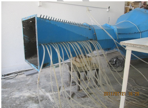
شکل ۴ اتصال شلنگ‌ها به سوراخ‌های فشار در دیفیوزر
