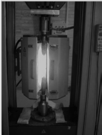
شکل ۴ دستگاه انجام آزمایش فشار و کوره
