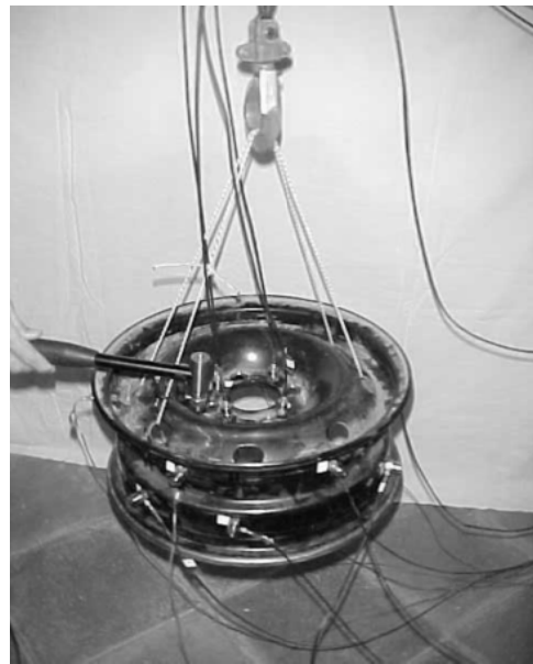
شکل ۱۱ رینگ چرخ خودرو پژوی ۴۰۵ در آزمایش OMA
