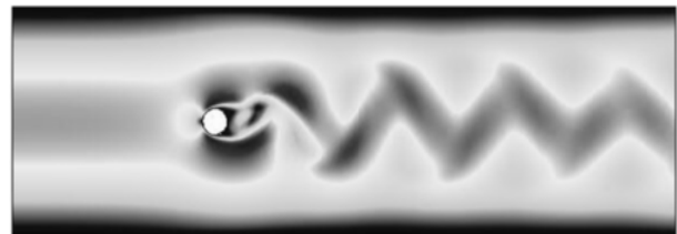
شکل ۳ کانتور جریان و گردابه‌های ایجاد شده در پشت سیلندر اصلی در حالت عدم وجود سیلندر کنترلی در Re=200 و t=100s
