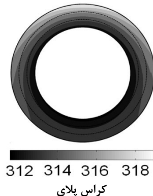
شکل ۸ کانتورهای توزیع دما برای آرایش الیاف مختلف در لمینیت نمونه اول
