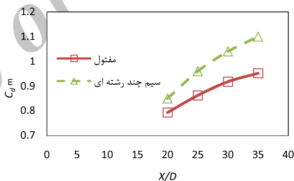
شکل ۸ توزیع ضریب نیروی پسا ناشی از اختلاف مومنتم بر حسب فاصله بی‌بعد شده در پایین دست مدل‌های مورد آزمایش برای عدد رینولدز ۱۵۷۰
