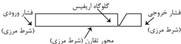
شکل ۸ مدل اریفیس به همراه شرایط مرزی به منظور استفاده در تحلیل CFD [۹]
