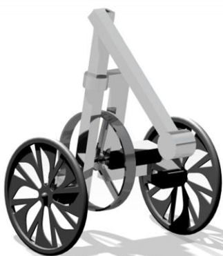
شکل ۱ طرح سه بعدی ربات دو چرخ بازودار به همراه چرخ عکس‌عملی
