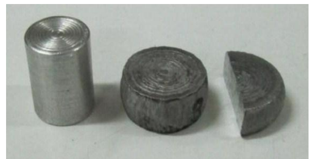
شکل ۴ نمونه‌های فشار (از راست به چپ): کاهش ارتفاع ۶۳٪ ، ۵۰٪ و قبل از تغییر شکل
