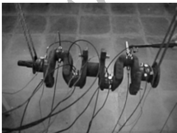
شکل ۲۰ میل لنگ، تحت آزمایش مودال کلاسیک
