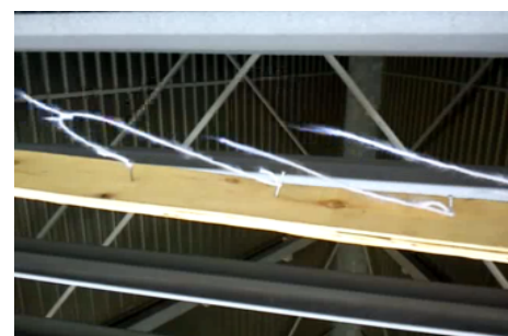
شکل ۱۷ الگوی جریان هوا در محل ۲ دلتای نامناسب
