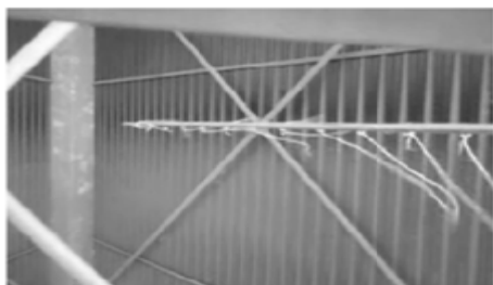
شکل ۱۹ الگوی جریان هوا در محل ۴ دلتای نامناسب
