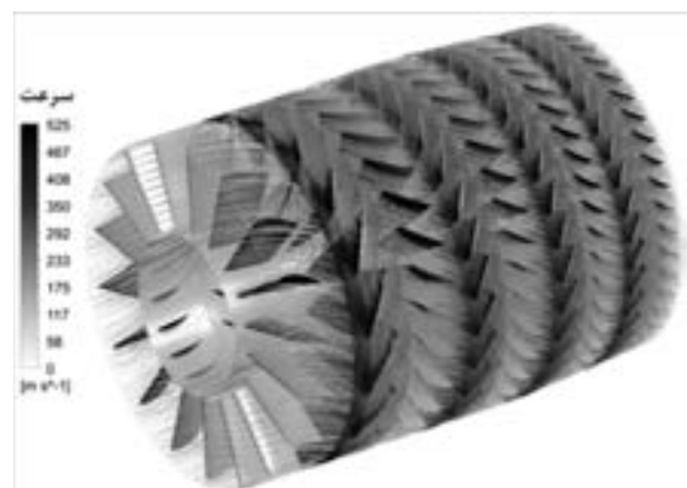
شکل ۱۳ خطوط جریان عبور کننده از پرها در نمای سه بعدی کمپرسور پیچش در قالب تغییرات زاویه استگر پره‌های روتور اولین طبقه
