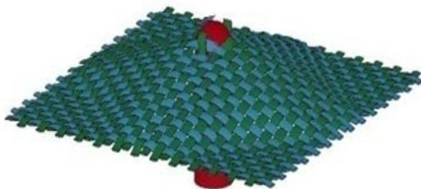
شکل ۵ شبیه‌سازی ضربه روی پارچه تک‌لایه با پرتابه سرکروی دارای سرعت اولیه ۲۲ m/s
