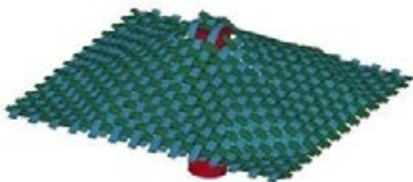
شکل ۶ شبیه‌سازی ضربه روی پارچه تک‌لایه با پرتابه سرتخت دارای سرعت اولیه ۱۶ m/s
