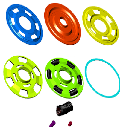
شکل ۹ اجزای چرخ طیار دو جرمی مدل‌سازی شده در نرم‌افزار مکانیکال دسکتاپ
