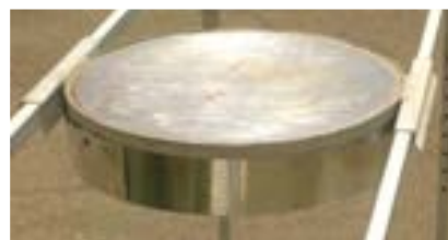
شکل ۴ صفحه پخت آلومینیومی و محافظ گالوانیزه‌ای آن
