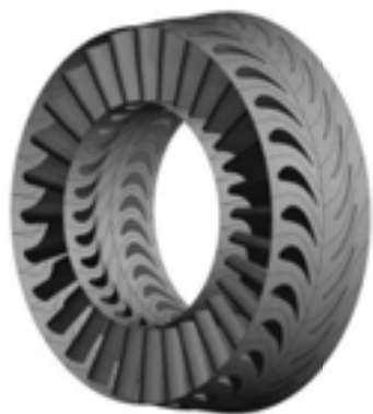
شکل ۵ هندسه سه بعدی توربین هانوفر
