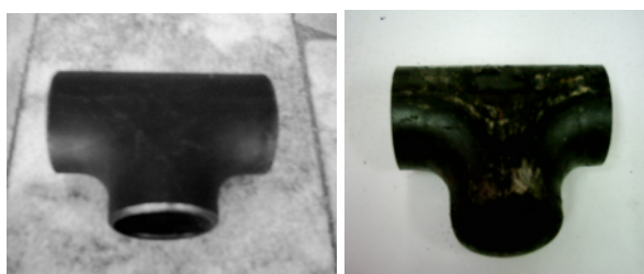
شکل ۶ سه راهی T شکل، قبل و بعد از آماده‌سازی نهایی
