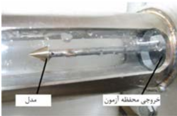
شکل ۳ نحوه قرارگیری مدل در محفظه آزمون
