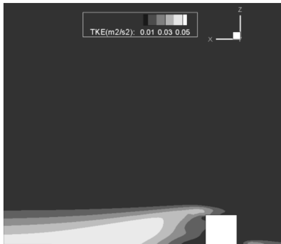
شکل ۲۱ مقدار انرژی توربولانسی در صفحه y = 5.5 با استفاده از مدل k-\varepsilon
