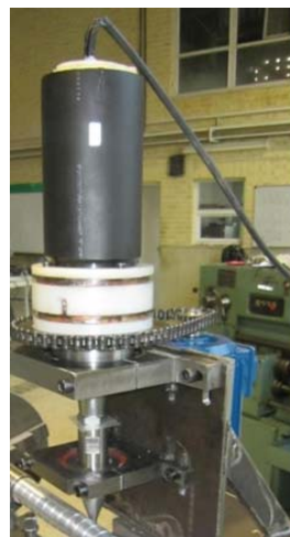
شکل ۱۱ ابزار چرخان ارتعاشی نصب شده بر روی دستگاه تراش
