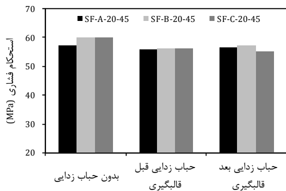
شکل ۱۶ میزان استحکام فشاری در ۹ فوم تولیدی به ۹ روش مختلف با ۶۰٪ حجمی میکروبالن و قالبگیری پس از ۴۵ دقیقه هم‌زدن نهایی
