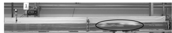
شکل ۱- ب جریان اسلاگ، U_{sl}=0.59\text{m/s} و U_{sg}=5.09\text{m/s} ، آزمایشگاه جریان چندفازی دانشگاه تربیت مدرس [
