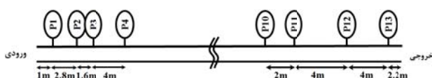
شکل ۵ طرحواره قرارگیری مبدل های فشار در طول کانال آزمایشگاه جریان چندفازی دانشگاه تربیت مدرس
