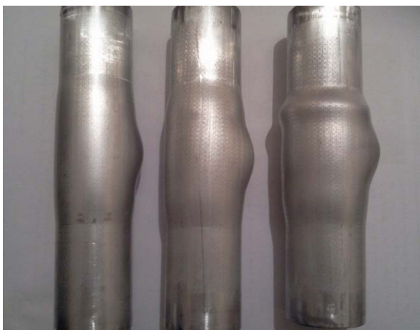
شکل ۱۲ تغییر قطر دایره‌ای حک شده بر روی لوله
