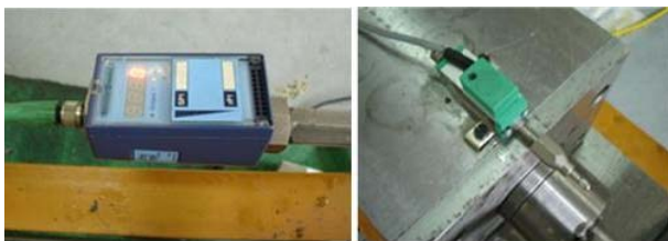
شکل ۶ ابزارهای اندازه‌گیری فشار و تغذیه محوری LVDT فشارسنج دیجیتال
