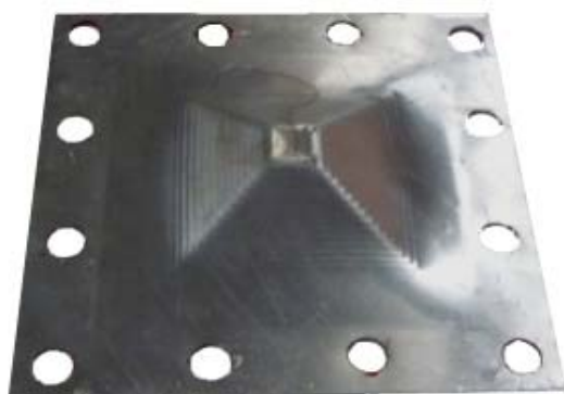
شکل ۱۱ قطعه به دست آمده در شرایط ضریب اصطکاک ۰۰/۰۵، قطر ابزار ۱۵ میلی متر و اندازه‌ی گام عمودی ۱/۵ میلی متر
