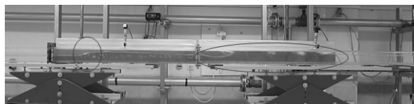
شکل ۱۳ اسلاگ تشکیل شده بعد از پرش هیدرولیکی در \alpha_l = 0.25 ، U_{sl} = 0.056 \text{ m/s} و U_{sg} = 3/20 \text{ m/s} (آزمایشگاه جریان چندفازی دانشگاه تربیت مدرس)
