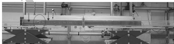
شکل ۱۲ پرش هیدرولیکی در \alpha_l = 0.25 به همراه افزایش سطح مایع، U_{sl} = 0.056 \text{ m/s} و U_{sg} = 3/20 \text{ m/s} (آزمایشگاه جریان چندفازی دانشگاه تربیت مدرس)
