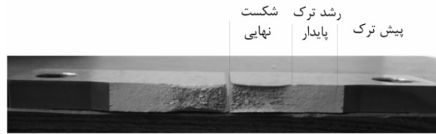
شکل 8 سطح شکست نمونه CT
