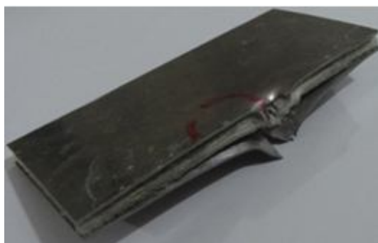
شکل 4 نمای برش خورده از جسم پس از آزمایش ضربه
