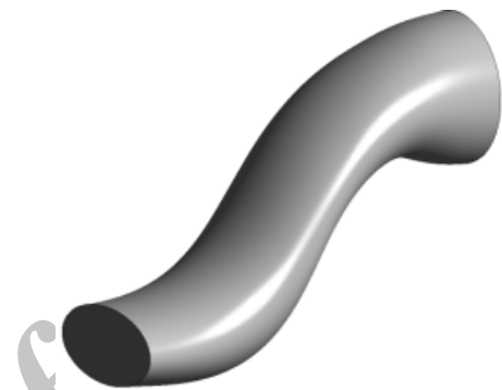
شکل ۱۴ هندسه مجرای سه بعدی با عرض ثابت و مقاطع بیضی
