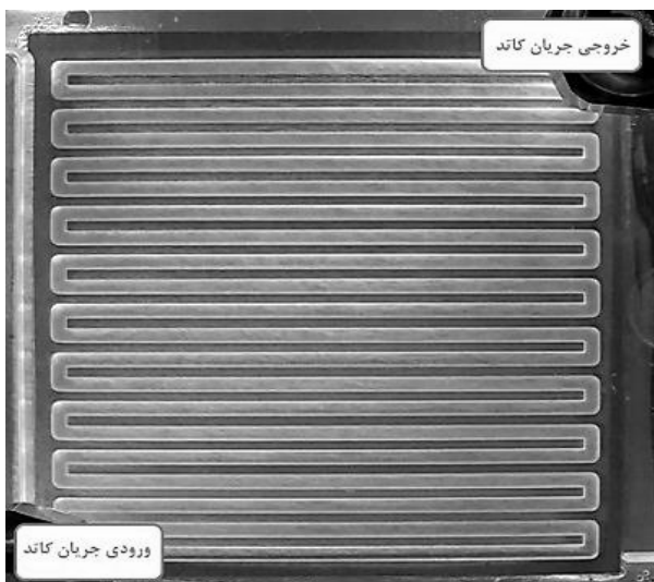
شکل ۱- الف کانال جریان سمت کاتد و محل ورودی و خروجی جریان اکسیژن
