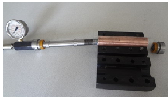
شکل ۶ قالب هیدروفرمینگ، لوله و تجهیزات آب‌بندی
