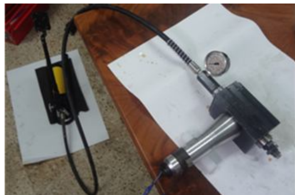
شکل ۹ آزمایش هیدروفرمینگ لوله آلتراسونیک
