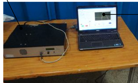
شکل ۸ اسکن واحد کنترل بر روی بازه فرکانسی و ایجاد گراف برای تشخیص فرکانس تشدید
