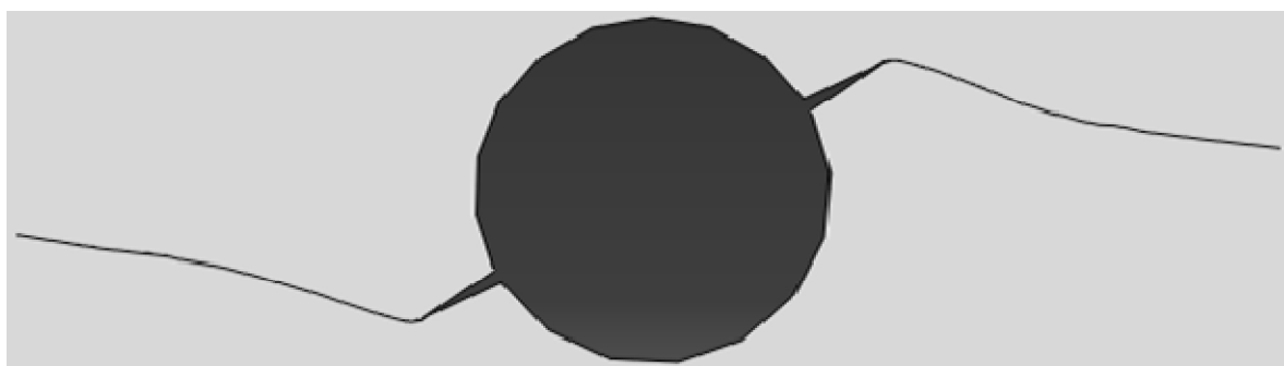
شکل ۱۴ رشد ترک در مدل ترک اولیه زاویه‌دار (با زاویه 30^\circ و 210^\circ درجه) تحت شرایط تنشی هایمسون
