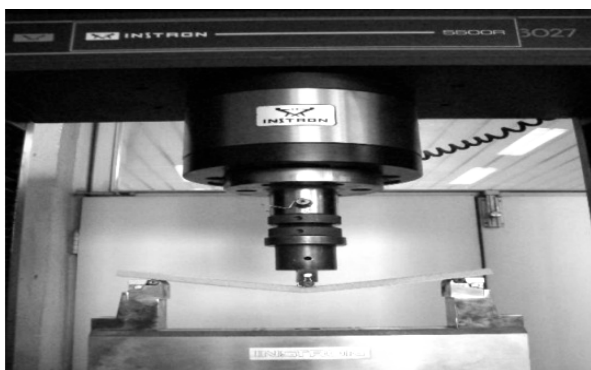
شکل ۳ آزمون خمشی سه نقطه‌ای طبق استاندارد ASTM-C393
