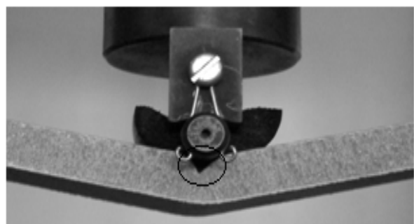
شکل ۷ شروع خرابی نمونه‌ی خمشی از رویه‌ی بالایی
